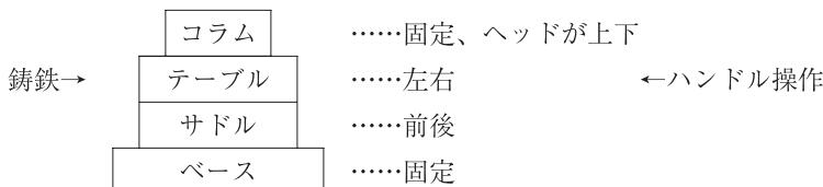
ベースは土台部分であり固定されている。最上層のコラムも固定されているが、中にスピンドルと砥石の入ったヘッドがあり、これが上下する。サドルは前後に、テーブルは左右に動き、ハンドル操作によってヘッドの動きとともに対象加工品（ワーク）を前後・左右・上下に研削するのである。この4層を生産して組立るのが研削用工作機械メーカーの仕事であり、各層のフレー
